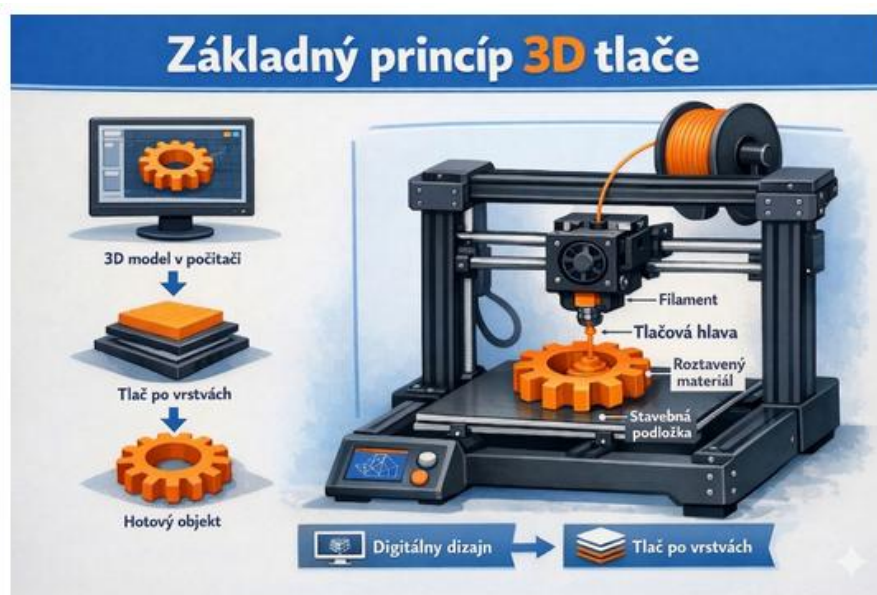
Obrázok 5 Základný princíp 3D tlače
