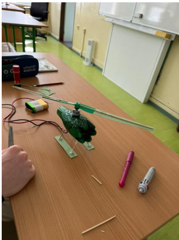
Obrázok 83 Skúmanie vplyvu dĺžky vrtule na vzlietnutie helikoptéry
